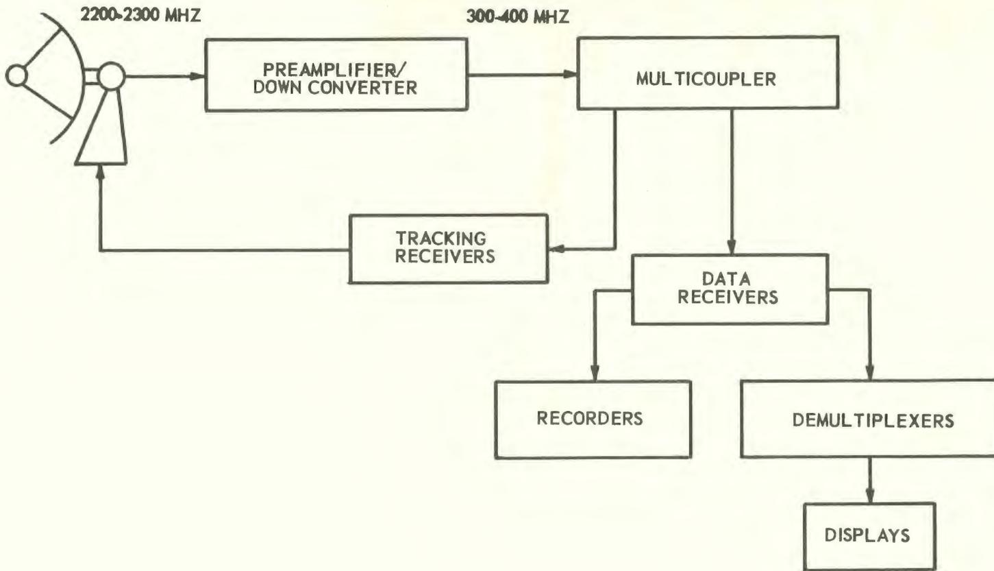
FIGURE 2 TYPICAL AFETR SUPPORT CONFIGURATION FOR ACQUISITION OF S-BAND TELEMETRY DATA
