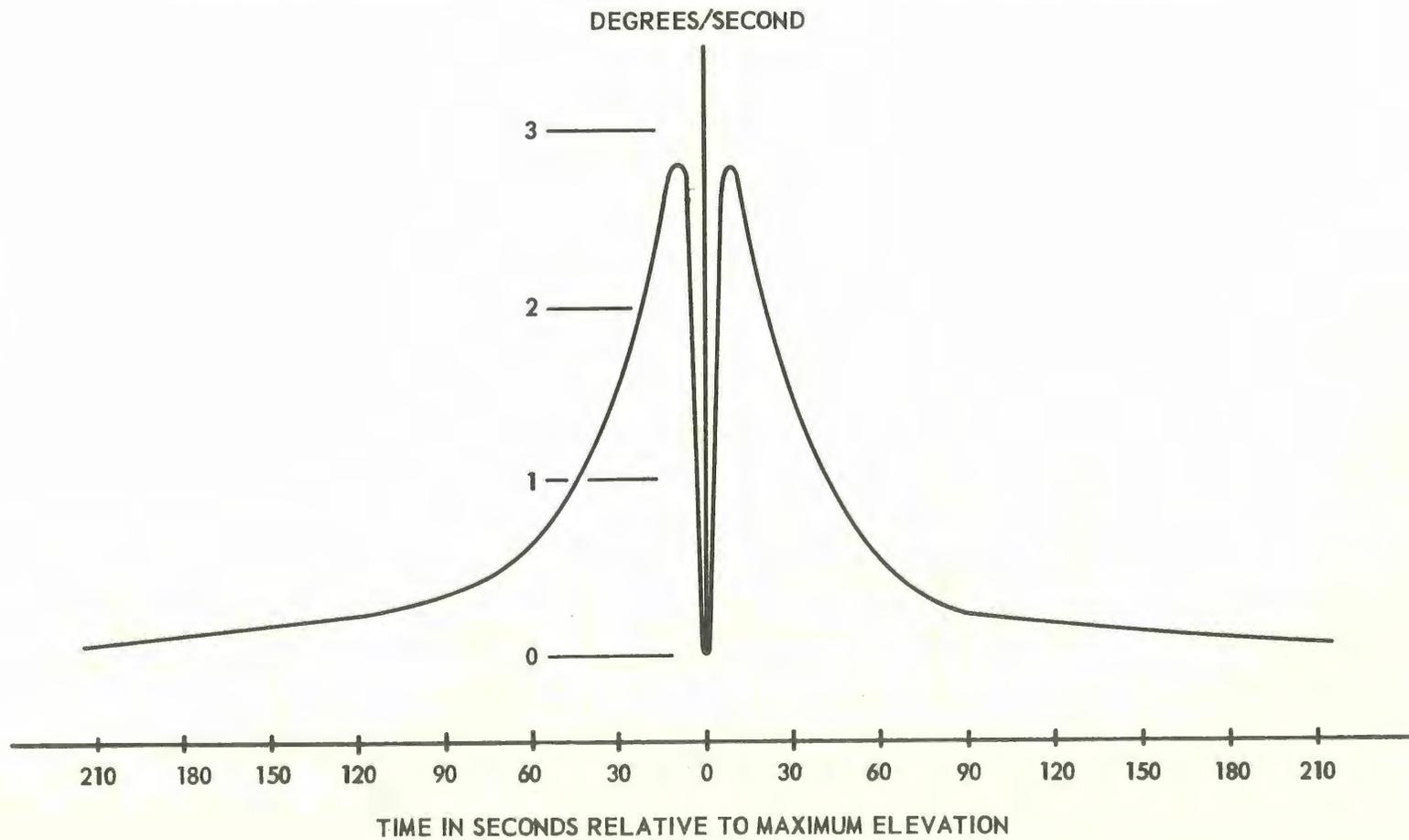
FIGURE 4 ANTENNA AZIMUTH VELOCITY FOR 100-NM CIRCULAR ORBIT
