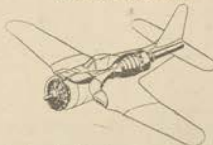
Um desenho do corte do Fireball FR-1 mostrando o motor Wright R-1820, as tomadas de ar, o motor de jato e o tubo da cauda.
